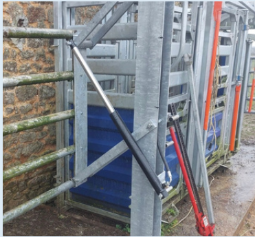
Fabrication châssis complet pour parc de contention réglable en largeur hydrauliquement
