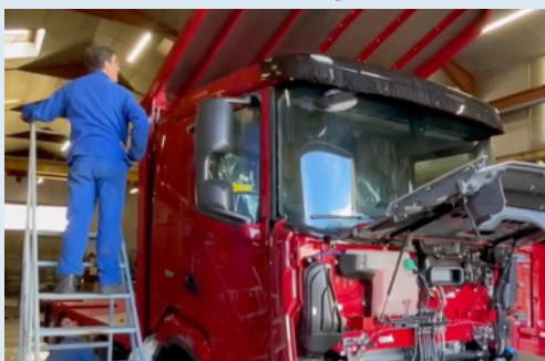
Montage « casquette » hydraulique sur un camion paille
