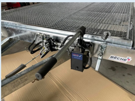
Système de basculement hydraulique sur remorque plateau
