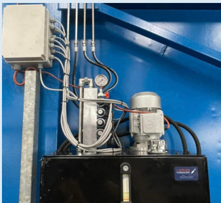
Remplacement complet du système hydraulique / électrique
